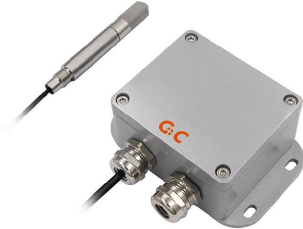
环境试验箱、老化试验箱等设备的湿度是非常重要的监测参数，设备运行过程中存在极限高低温以及高湿环境，对于湿度测量带来非常大的挑战。PTH40 湿度探头的湿敏元件为高分子薄膜湿敏电容，同时辅助 PT1000 温敏元件，可以进行温度补偿，确保精确测量。
